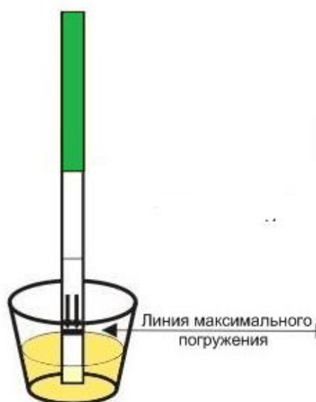
Рисунок 1 – Схема тестирования тест-полоской
